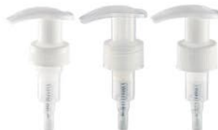
27#-2 液体分配器 剂量 2ml PUMP 27#-2, Output: 2ml 850PCS/CTN, Meas.: 45 X 39 X 57cm DIA: Ø28/400 Ø28/410
