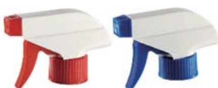
E-4 型喷头 剂量 0.9 \pm 0.05\text{ml} TRIGGER SPRAYER E-4 0.9 \pm 0.05\text{ml} 550PCS/CTN meas.: 45X39X57cm DIA: Ø28/400 Ø28/410
